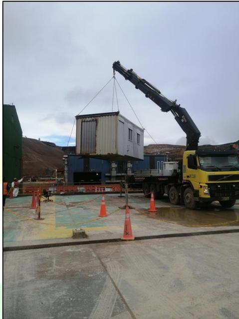
**Artículo 109°** Asegúrese de que la grúa que va a operar cuente con la tabla de cargas, manual de operación y registro de inspección anual dentro del equipo. La tabla de cargas con los ángulos de izaje debe estar ubicada en una parte visible para el operador.
